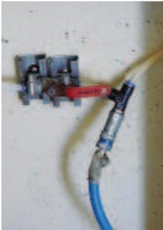
Les éleveurs profitent des tuyaux à air comprimé qui alimentent des portes, pour poser un robinet de dérivation, sur lequel il branche un pistolet à huile pneumatique.
