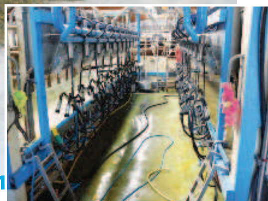
Le bâtiment s'avère fonctionnel et bien aéré. L'absence d'un caillebotis au bout des quais de traite provoque une arrivée d'eau dans les couloirs de la stabulation.
