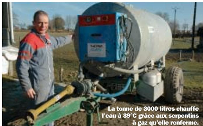
La tonne de 3000 litres chauffe l'eau à 39°C grâce aux serpentins à gaz qu'elle renferme.
